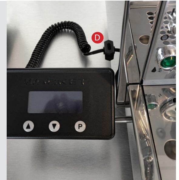
Abb. D Bei abgeschalteter Maschine: schließen Sie die PID Programmierereinheit an die serielle Schnittstelle an der unteren Seite Ihrer R58 / R 60V an.
