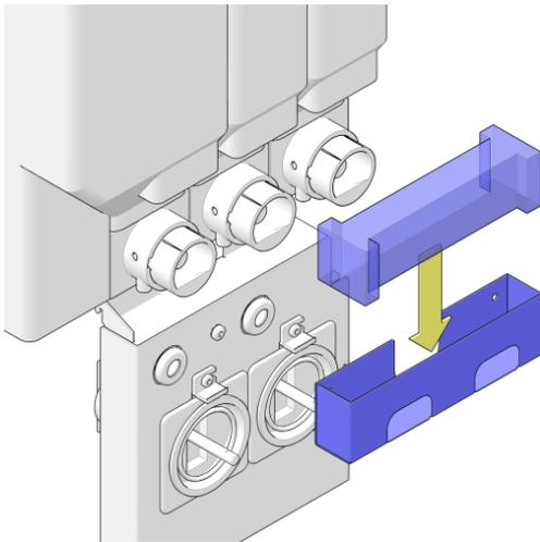
12. Setzen Sie den Austrittsfilter des Mischers in das Filterfach ein.
