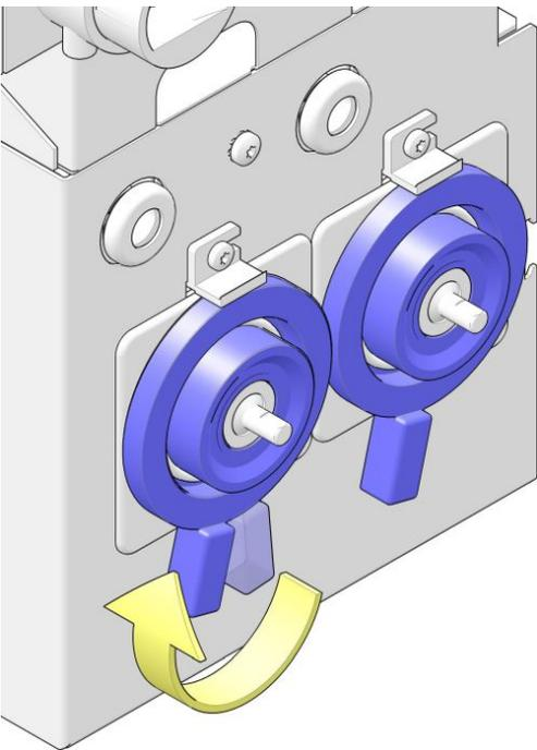
15. Setzen Sie die Mischerpropeller auf.
