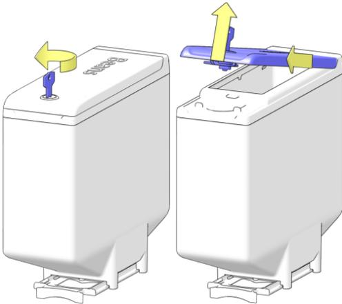
7. Entriegeln Sie den Deckel (optional). Heben Sie den Deckel vorne an und ziehen Sie ihn in Pfeilrichtung vom Behälter.
