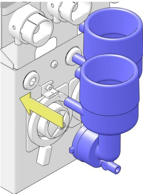
17. Drehen Sie die Bajonettverschlüsse im Uhrzeigersinn, um die Mischergehäuse zu verriegeln.
