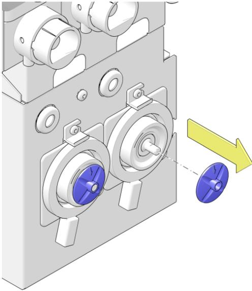
5. Ziehen Sie den Mischerpropeller in Pfeilrichtung von der Welle ab.
