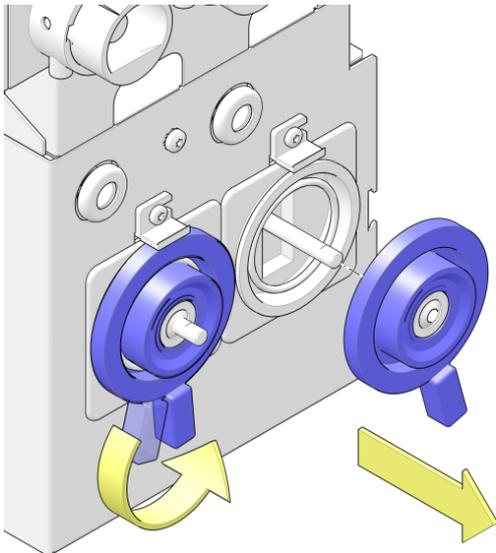
6. Drehen Sie die Bajonettverschlüsse erneut gegen den Uhrzeigersinn (um etwa  $10^\circ$ ), um sie zu lösen und ziehen Sie diese in Pfeilrichtung vom Automaten ab.
