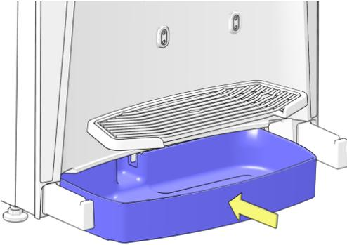
7. Setzen Sie den Kannenhalter in die Führungen (2) ein und schieben Sie diesen in Pfeilrichtung.
