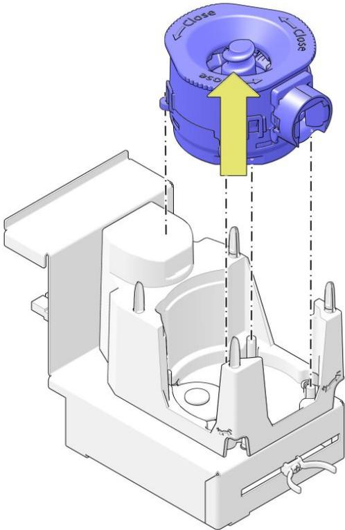
6. Ziehen Sie die Clips am Mühlenauslass (1) heraus, schieben Sie den Auslass aus dem Mühlengehäuse (2) und nehmen Sie ihn aus der Mühle.
