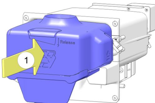
7. Setzen Sie den Brühler in den Halterahmen und drücken Sie ihn ein, bis er einrastet.
