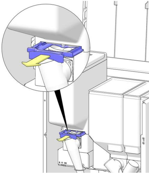
4. Ziehen Sie diesen Verschlusschieber in Pfeilrichtung. Der Bohnenbehälter kann geschlossen und von der Mühlenhalterung abgenommen werden.
