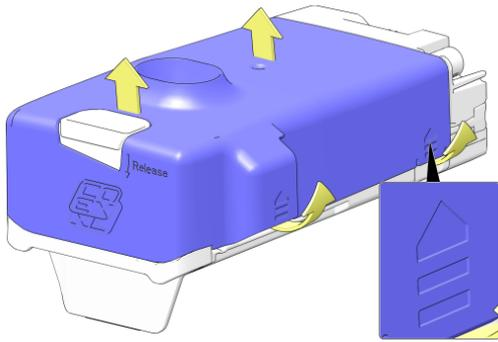
3. Legen Sie den Brühler auf eine ebene Fläche. Suchen Sie die Markierungen zum Lösen des Deckels an den Seiten des Brühers (kleines Bild). Ziehen Sie die Seiten in der Nähe dieser Markierungen einige Millimeter vom Brühler weg und heben Sie den Deckel vom Brühler ab.
