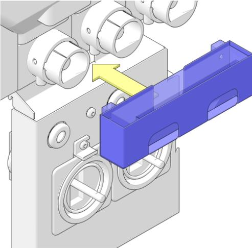
14. Bringen Sie die Bajonettverschlüsse an und drehen Sie diese im Uhrzeigersinn (etwa um 10°).
