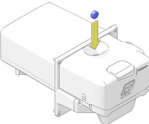
6. Wenn das zweite Untermenü (Schritt 2) angezeigt wird, geben Sie eine Reinigungstablette in den Brüher.
