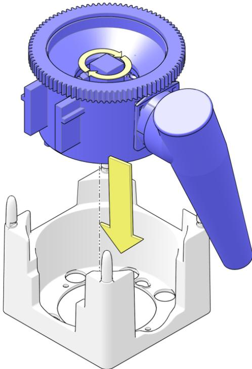
4. Setzen Sie die Mühle wieder auf den Sockel und fahren Sie mit Schritt 12 fort.
