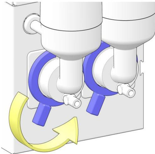
3. Drehen Sie die Bajonettverschlüsse gegen den Uhrzeigersinn (etwa um 10°).
