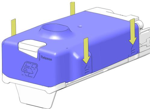
5. Setzen Sie den Deckel auf den Brühler und drücken Sie ihn nach unten. Überprüfen Sie, ob alle Seiten eingerastet sind.
