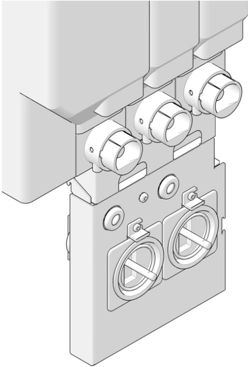
10. Reinigen Sie die im Automaten verbliebenen Teile des Mischersystems mit einer Bürste.
