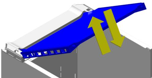
1. Zum Öffnen heben Sie den oberen Deckel vorne an und schwenken ihn nach hinten. Der obere Deckel bleibt in der senkrechten Position stehen.
