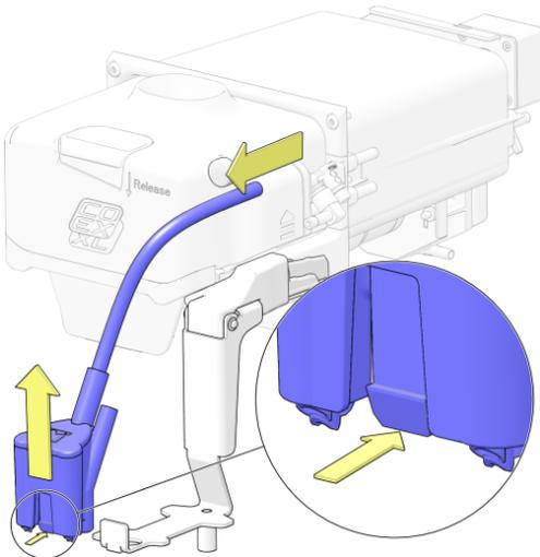
2. Nehmen Sie den Brühler aus dem Kaffeeautomaten: legen Sie vier Finger in den unteren Griff (1). Drücken und halten Sie mit dem Daumen den Verriegelungsgriff (2) und ziehen Sie den Brühler in Pfeilrichtung (3) aus dem Halterahmen.
