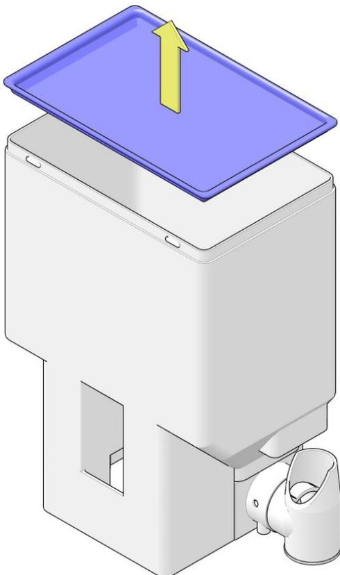
6. Entfernen Sie den Deckel und stellen Sie den Behälter auf eine stabile Fläche.
