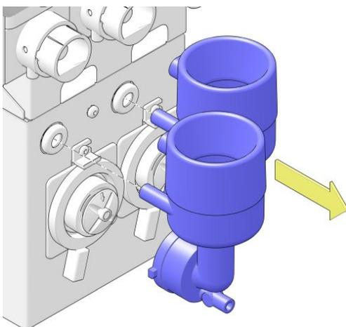
4. Ziehen Sie die Mischergehäuse in Pfeilrichtung ab und nehmen Sie diese aus dem Automaten.
