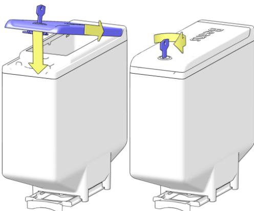
9. Setzen Sie die Rückseite des Deckels auf den Behälter und senken Sie den Deckel vorne ab. Verriegeln Sie den Deckel (optional).
