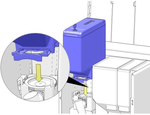
11. Schieben Sie den Verschlusschieber in Pfeilrichtung zurück, um den Bohnenbehälter zu öffnen und an der Mühlenhalterung zu befestigen.
