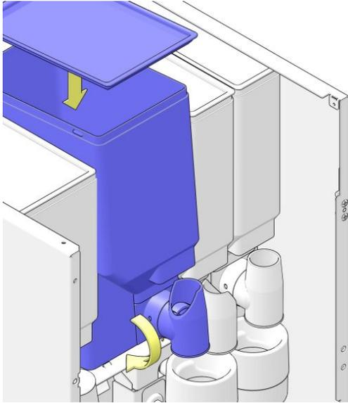
8. Bringen Sie den Deckel wieder auf dem Behälter an und setzen Sie den Behälter in den Automaten ein.
