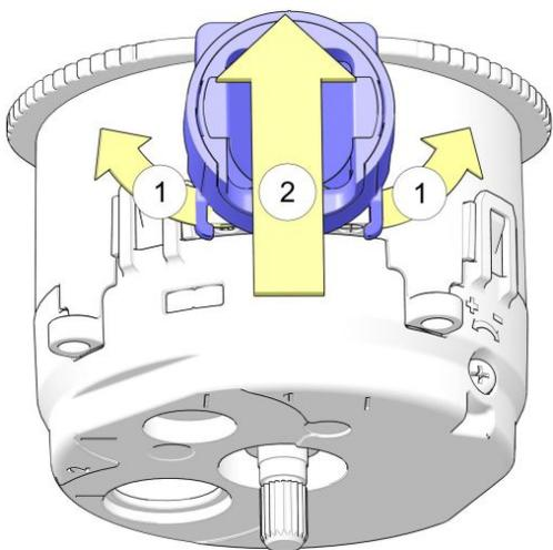
7. Lösen Sie den Bajonettverschluss des Mühlengehäusedeckels in Pfeilrichtung und nehmen Sie den Deckel von der Mühle ab.
