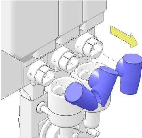
2. Koppeln Sie die Behälterauslässe ab und merken Sie sich die jeweilige Position und Ausrichtung jedes Auslasses.
