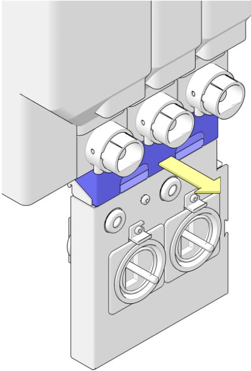
7. Ziehen Sie das Austrittsfilterfach in Pfeilrichtung und nehmen Sie es aus dem Automaten.
