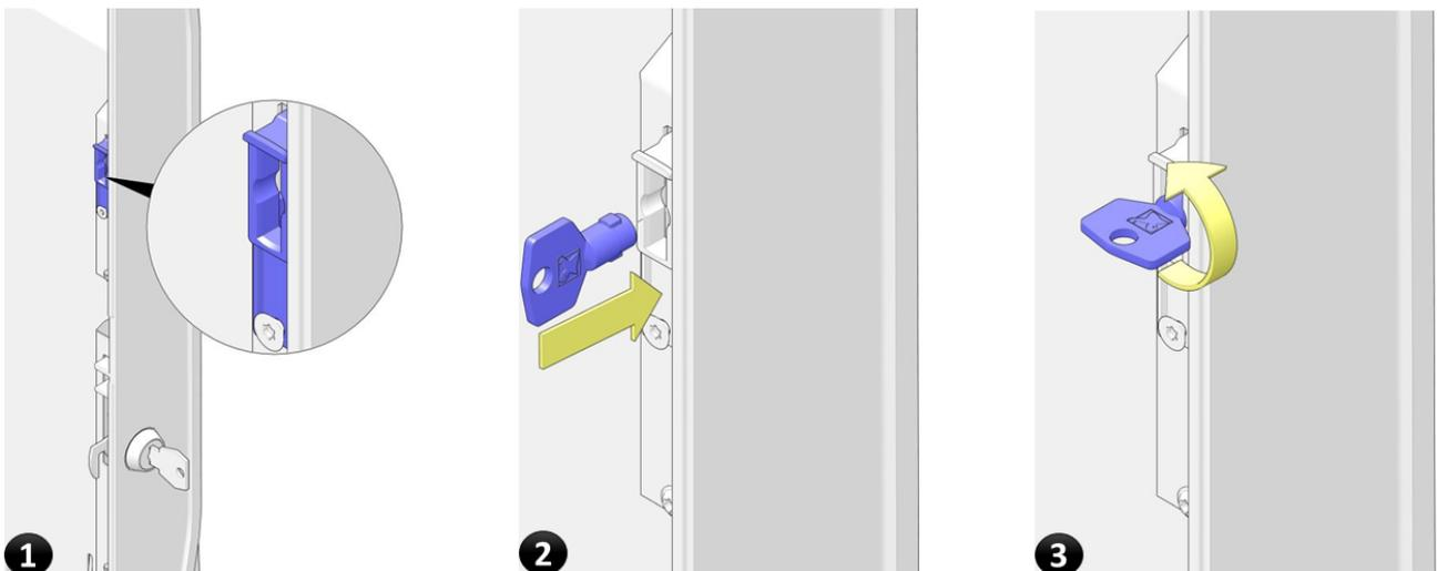
1. Auf der Innenseite der Tür befindet sich ein Einsteckschlitz für den **Serviceschlüssel**.
