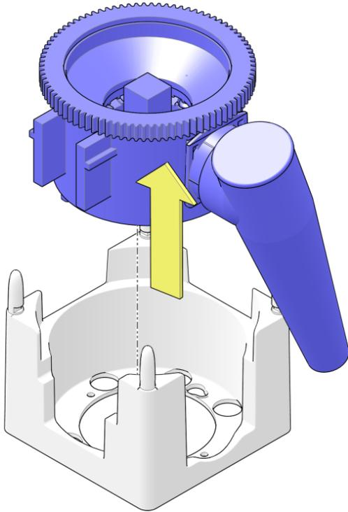
2. Zum Reinigen der Schaerer-Mühle heben Sie die Mühle an und nehmen sie vom Sockel ab.
