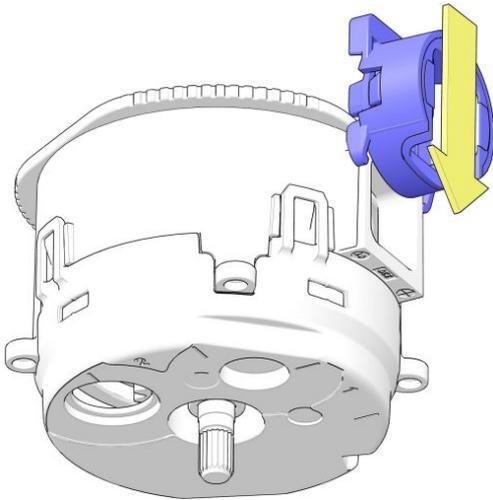
10. Schieben Sie den Auslass in Pfeilrichtung auf das Mühengehäuse.
