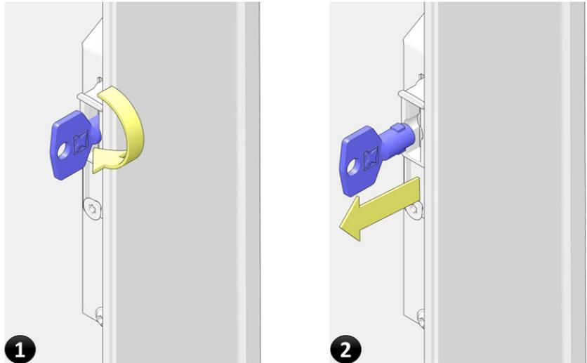
1. Drehen Sie den **Serviceschlüssel** eine Viertelumdrehung (90°).
